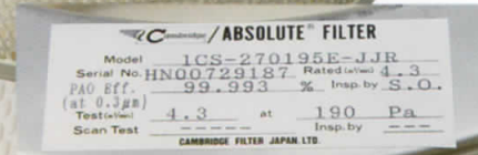
HEPA フィルター銘板
